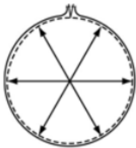
(d) Excessive internal hydrostatic pressure
